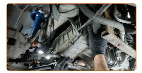
Serra gli elementi di fissaggio del coperchio inferiore della coppa dell'olio. Usa la chiave Torx T27.
