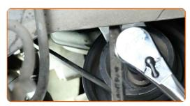
Gira la puleggia dell'albero motore. Utilizza una chiave a bussola N°18. Usa un giramaschi.
