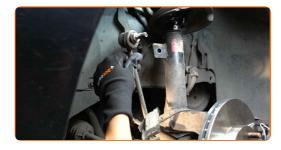
Pulisci le sedi di montaggio del tirante della barra stabilizzatrice. Usa una spazzola metallica. Usa lo spray WD-40.
