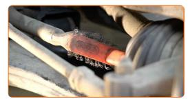
Installare una nuova barra, serrarne gli elementi di montaggio. Utilizza una chiave combinata N°15. Utilizza una chiave a bussola N°15. Usa una chiave a cricchetto.
