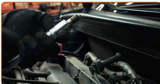
**14** Applica uno strato sottile dello speciale lubrificante antigrippaggio per alte temperature alle filettature delle candele nuove.
