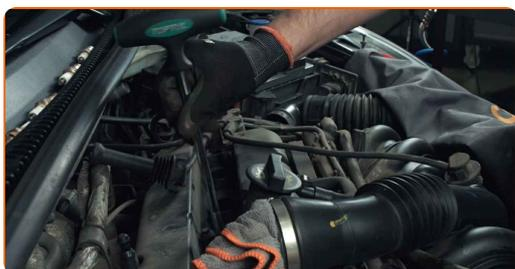
**16** Avvitare le nuove candele e serrarle. Usa la chiave a bussola per candele numero 16. Usa una chiave dinamometrica. Serralo fino allo coppia di torsione di 15 Nm.
