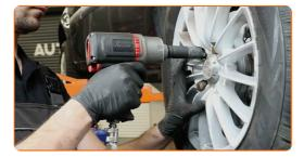
Rimettere il veicolo per terra e, lavorando in ordine incrociato, serrare i bulloni di fissaggio delle ruote. Usa la chiave a bussola per dadi cerchio ruota n.19. Usa una chiave dinamometrica. Serralo fino allo coppia di torsione di 95 Nm.
