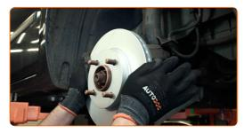
20 Installare il sostegno pinza freno.
