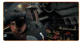
Pulisci gli elementi di fissaggio del supporto pinza freno. Usa una spazzola metallica. Usa lo spray WD-40.
