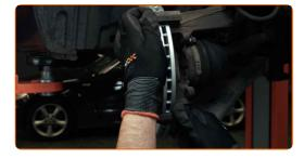
Serrare il sostegno pinza freno. Utilizza una chiave a bussola N°13. Usa una chiave dinamometrica. Serralo fino allo coppia di torsione di 70 Nm.
