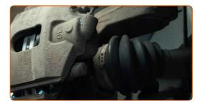
27 Installare la molla di fissaggio della pinza freno.
