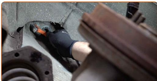
**19** Collocare l'ammortizzatore nell'arco passaruota e fissalo.
