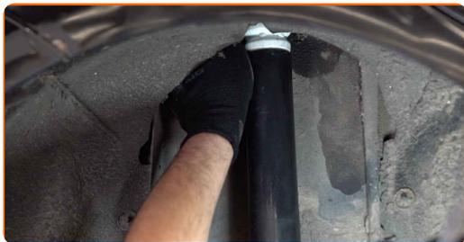
**21** Avvita gli elementi di fissaggio del supporto dell'ammortizzatore. Utilizza una chiave a bussola N°10. Usa una chiave a cricchetto.
