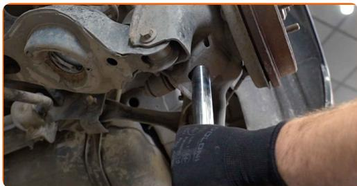
**23** Stringi l'elemento di fissaggio inferiore dell'ammortizzatore. Utilizza una chiave a bussola N°16. Usa una chiave dinamometrica. Serralo fino allo coppia di torsione di 103 Nm.
