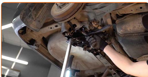
**24** Stringere l'elemento di fissaggio del supporto di ammortizzazione. Utilizza una chiave a bussola N°10. Usa una chiave dinamometrica. Serralo fino allo coppia di torsione di 25 Nm.
