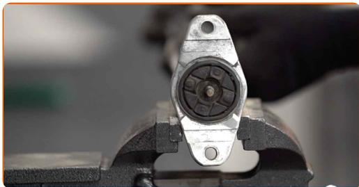
**17** Avvitare il fissaggio superiore dell'asta pistone ammortizzatore. Utilizza una chiave combinata N°13. Utilizza una chiave a bussola N°13. Usa una chiave regolabile. Usa una chiave dinamometrica. Serralo fino allo coppia di torsione di 25 Nm.
