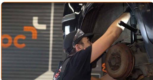
**20** Installa il supporto montante dell'ammortizzatore usando il buco centrale come guida.
