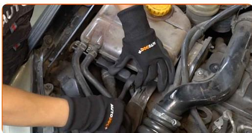
**4** Rilasciare le clip di fissaggio del serbatoio del liquido di raffreddamento. Usa un giravite piatto.
