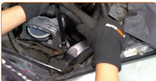
**15** Avvitare l'elemento di fissaggio superiore del supporto del motore. Utilizza una chiave a bussola N°16. Usa una chiave a cricchetto.
