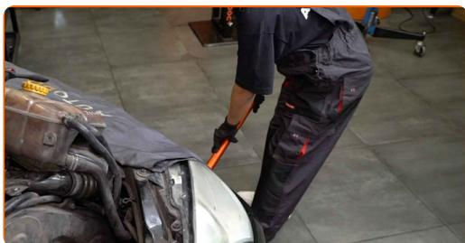
**14** Avvitare gli elementi di fissaggio che collegano il supporto del motore alla carrozzeria. Utilizza una chiave a bussola N°16. Usa una chiave a cricchetto.
