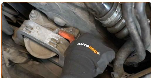
**8** Svita gli elementi di fissaggio superiori del supporto del motore. Utilizza una chiave a bussola N°16. Usa una chiave a cricchetto.
