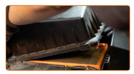
Rimuovere dall'alloggiamento del filtro l'elemento filtrante da sostituire.
