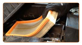
Pulisci il coperchio del filtro dell'aria e l'alloggiamento.
