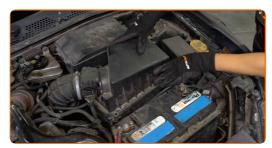
Avvita le viti di serraggio sul coperchio del filtro dell'aria. Utilizza una chiave a bussola N°8. Usa una chiave a cricchetto.
