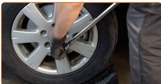
**3** Sollevare la parte posteriore del veicolo e fissarlo per mezzo di appoggi.
