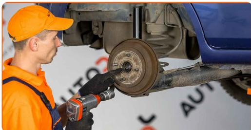
**9** Svitare la staffa di fissaggio del cuscinetto del mozzo della ruota. Utilizza una chiave a bussola N°30.
