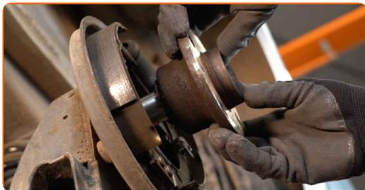
**12** Pulisci la sede di montaggio del cuscinetto del mozzo. Usa un detergente spray multiuso.
