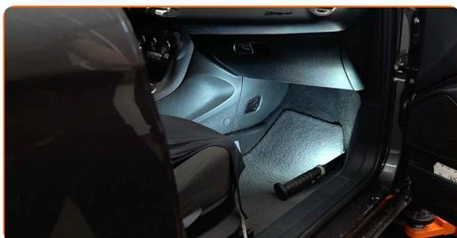
**2** Fai leva, delicatamente allenta gli elementi di fissaggio e rimuovi la copertura in plastica del lato passeggero.
