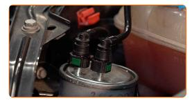
Stringi le clip e stacca i tubi di rifornimento carburante dall'alloggiamento del filtro dell'olio. Usa le pinze per raccordi tubi carburanti.
