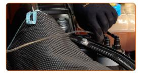
Avvita la valvola di spurgo del filtro carburante. Utilizza una chiave a bussola N°12. Usa una chiave a cricchetto.
