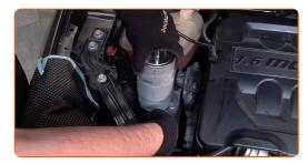
Scollega il connettore del sensore di pressione del carburante.
