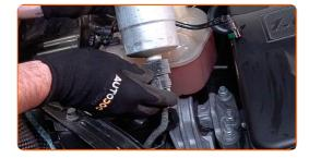
Collega il connettore del sensore di pressione carburante.
