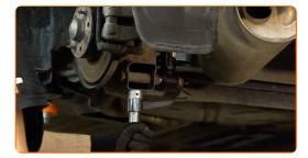
Stringi l'elemento di fissaggio inferiore dell'ammortizzatore. Utilizza una chiave a bussola N°19. Usa una chiave dinamometrica. Serralo fino allo coppia di torsione di 110 Nm.
