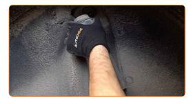
Rimuovi il parapolvere e il paracolpi dell'ammortizzatore.
