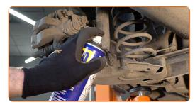
Avvita l'elemento di fissaggio inferiore dell'ammortizzatore. Utilizza una chiave a bussola N°19. Usa un giramaschi.
