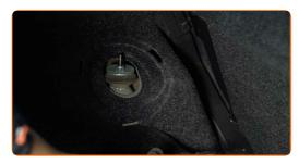
Allenta l'elemento di fissaggio superiore dall'ammortizzatore. Utilizza una chiave combinata N°17. Utilizza le pinze di autobloccanti.
