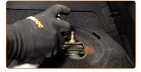
Installa la cuffia del supporto sull'elemento di fissaggio superiore dell'ammortizzatore.
