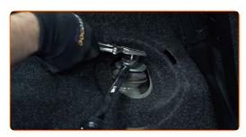
Rimuovi i bulloni di fissaggio. Utilizza una chiave a bussola N°19.
