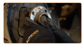
Pulisci la sede di montaggio del cuscinetto del mozzo. Usa un detergente spray multiuso.
