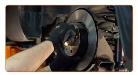
Serrare l'attacco del disco freno. Utilizza una chiave a bussola N°12. Usa una chiave dinamometrica. Serralo fino allo coppia di torsione di 10 Nm.
