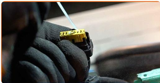
**14** Collega il connettore del sensore di pressione carburante.
