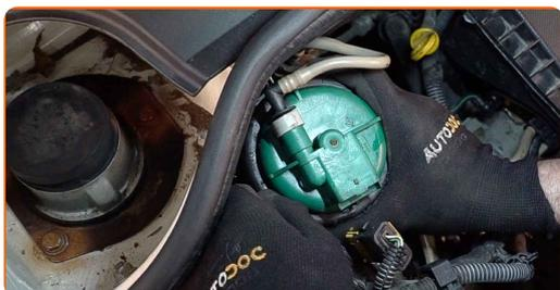
**13** Pulisci il connettore del regolatore di pressione del carburante. Usi uno spray per dispositivi elettronici.
