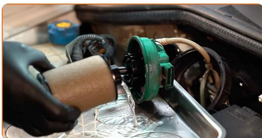
**9** Fissare il filtro del combustibile nel supporto.
