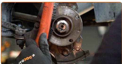
**20** Pulisci la superficie del disco freno. Usa un detergente spray multiuso.
