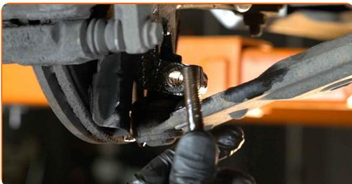
**9** Svita l'elemento di fissaggio anteriore del braccio. Utilizza una chiave a bussola N°E18. Usa un giramaschi.
