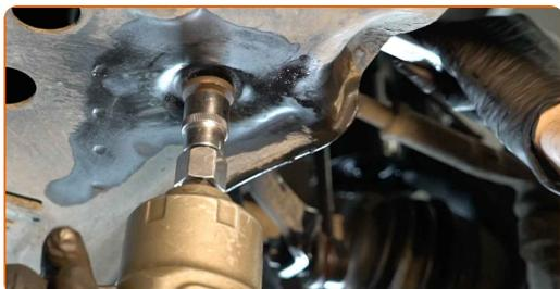
**24** Serra gli elementi di fissaggio anteriori che collegano il braccio di controllo al sottotelaio. Utilizza una chiave a bussola N°E18. Usa una chiave dinamometrica. Serralo fino allo coppia di torsione di 60 Nm. +90°
