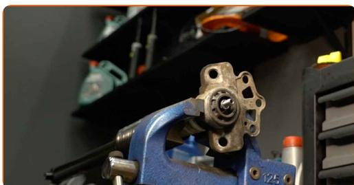
**22** Pulisci le sedi di montaggio dell'ammortizzatore. Usa una spazzola metallica. Usa lo spray WD-40.
