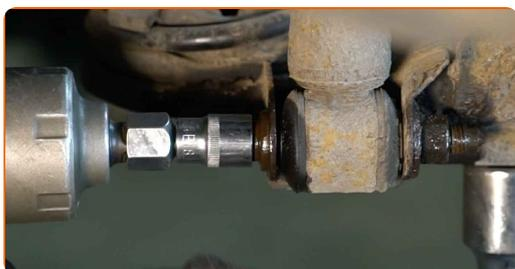
**11** Svita l'elemento di fissaggio superiore dell'ammortizzatore. Utilizza una chiave a bussola N°E16. Usa una chiave a cricchetto.
