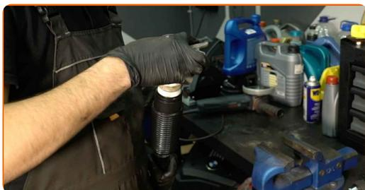
**20** Stringere il dado dell'asta dell'ammortizzatore. Usa la chiave a bussola per ammortizzatore DDN<sup>o</sup>6. Utilizza una chiave a bussola N°16. Usa una chiave dinamometrica. Serralo fino allo coppia di torsione di 35 Nm.
