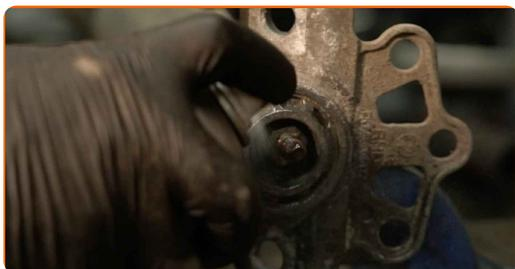
**17** Rimuovere l'elemento di fissaggio dell'asta pistone ammortizzatore. Usa la chiave a bussola per ammortizzatore DDN°6. Utilizza una chiave a bussola N°16. Usa una chiave a cricchetto.
