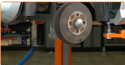
**6** Svita gli elementi di fissaggio del parasassi del passaruota. Utilizza una chiave a bussola N°10. Usa una chiave a cricchetto.
