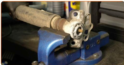
**16** Pulisci l'elemento di fissaggio dell'asta dell'ammortizzatore. Usa una spazzola metallica. Usa lo spray WD-40.
