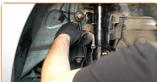
**12** Serra gli elementi di fissaggio che collegano il tirante della barra stabilizzatrice al puntone dell'ammortizzatore. Utilizza una chiave a bussola N°17. Usa una chiave dinamometrica. Serralo fino allo coppia di torsione di 50 Nm.
