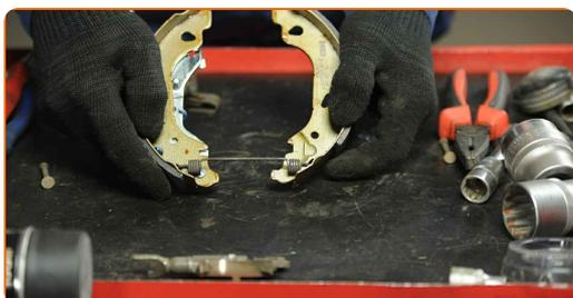
**21** Collegare il cavo del freno di stazionamento al braccio della ganasce freno.
