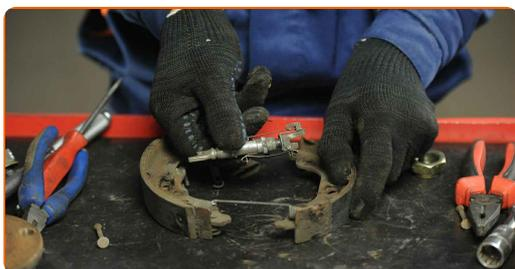
**20** Monta le molle di arresto superiori e il meccanismo di regolazione sulle nuove ganasce del freno.
