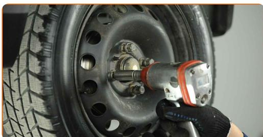
**35** Rimettere il veicolo per terra e, lavorando in ordine incrociato, serrare i bulloni di fissaggio delle ruote. Usa una chiave dinamometrica. Serralo fino allo coppia di torsione di 98 Nm.
