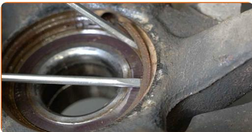
**43** Pulisci la sede di montaggio del cuscinetto del mozzo. Usa una spazzola metallica. Usa lo spray WD-40.
