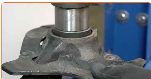
**46** Pulisci la sede di montaggio del cuscinetto del mozzo. Usa una spazzola metallica. Usa lo spray WD-40.
