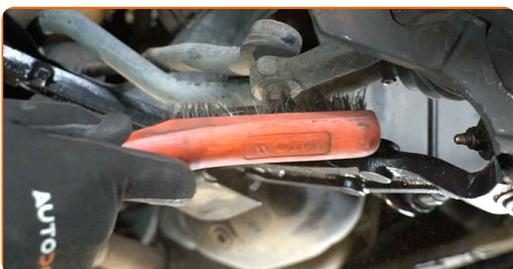
**25** Svitare il dado di attacco del gambo al fuso a snodo. Utilizza una chiave a bussola N°17. Usa una chiave a cricchetto.
