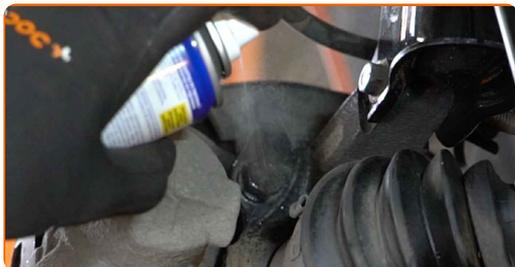
**19** Svitare l'attacco della staffa pinza freno. Utilizza una chiave a bussola N°18. Usa un giramaschi. Usa una chiave a cricchetto.
