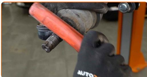
**52** Pulisci l'elemento di fissaggio che collega le testine tiranti al fuso a snodo. Usa una spazzola metallica. Usa lo spray WD-40.
