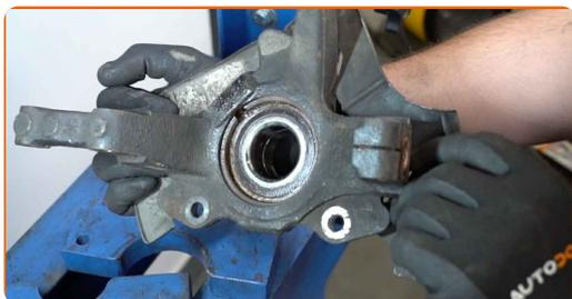
**45** Estrarre il cuscinetto del mozzo della ruota. Usare un set di montaggio/smontaggio cuscinetti e boccole.
