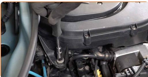
**4** Rimuovi la molla di ritenuta dell'alloggiamento del filtro dell'aria.
