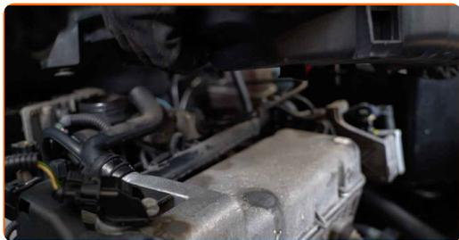
**6** Copri il corpo della farfalla con un panno in microfibra per evitare che la polvere e lo sporco possano penetrare all'interno del sistema.
