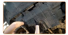
Serra gli elementi di fissaggio del coperchio inferiore della coppa dell'olio. Utilizza una chiave a bussola N°10. Usa una chiave a cricchetto. Usa un cacciavite Phillips.
