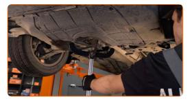
Rimuovi il coperchio della coppa dell'olio. Rimuovi il cric per trasmissione idraulica.
