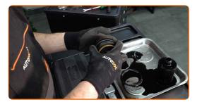
Lubrifica la guarnizione di gomma del filtro nuovo con una piccola quantità di olio fresco.
