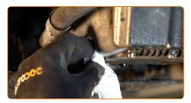
Avvita il nuovo tappo di drenaggio e stringerlo. Utilizza una chiave a bussola N°17. Usa una chiave dinamometrica. Serralo fino allo coppia di torsione di 22 Nm.
