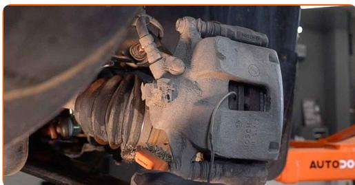
**10** Svitare l'attacco della pinza freno. Utilizza una chiave a bussola N°13. Usa una chiave a cricchetto.
