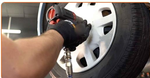
**23** Rimettere il veicolo per terra e, lavorando in ordine incrociato, serrare i bulloni di fissaggio delle ruote. Usa una chiave dinamometrica. Serralo fino allo coppia di torsione di 86 Nm.
