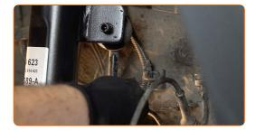
Serra gli elementi di fissaggio che collegano il tirante della barra stabilizzatrice al puntone dell'ammortizzatore. Utilizza una chiave combinata N°17. Usa una chiave dinamometrica. Serralo fino allo coppia di torsione di 55 Nm.
