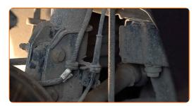
Pulisci gli elementi di fissaggio che collegano il puntone stabilizzatore al puntone dell'ammortizzatore, e quelli che collegano il puntone dell'ammortizzatore al fuso a snodo.
