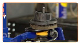
Serrare la vite dell'asta pistone supporto ammortizzazione. Utilizza una chiave combinata N°19. Usa una chiave HEX N.H6. Usa una chiave dinamometrica. Serralo fino allo coppia di torsione di 60 Nm.
