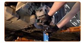
Svita gli elementi di fissaggio che collegano il puntone dell'ammortizzatore al fuso a snodo. Utilizza una chiave combinata N°15. Utilizza una chiave a bussola N°17. Usa un giramaschi.
