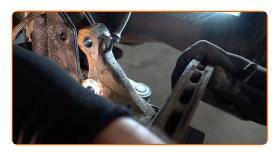
Svita l'elemento di fissaggio superiore del montante supporto ammortizzazione. Utilizza una chiave a bussola N°19. Usa una chiave a cricchetto.
