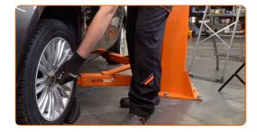
Stringi l'elemento di fissaggio superiore del supporto di ammortizzazione. Utilizza una chiave a bussola N°19. Usa una chiave dinamometrica. Serralo fino allo coppia di torsione di 44 Nm.
