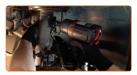
Puntellare il fuso a snodo. Usa un cric idraulico per trasmissione.
