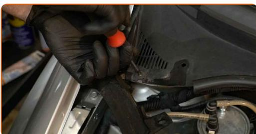
**5** Rimuovi la guarnizione griglia sottoparabrezza.
