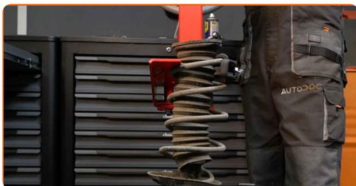
**30** Rimuovi il parapolvere e il paracolpi dell'ammortizzatore.
