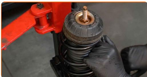
**42** Installare il supporto di ammortizzazione nell'arco passaruota.
