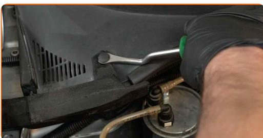
**4** Svitare gli elementi di fissaggio della griglia sottoparabrezza. Usa un cacciavite Phillips.
