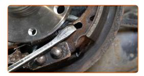
Rimuovere i perni di fermo delle ganasce dei freni. Usa delle pinze a becchi lunghi.
