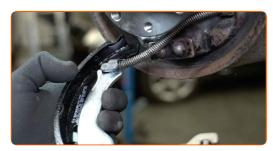
Installare le ganasce del freno sul cilindretto apriceppi e sulla staffa del supporto.
