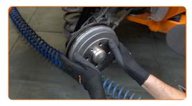
Avvitare l'elemento di fissaggio del tamburo del freno. Utilizza una chiave a bussola N°12. Usa una chiave a cricchetto.
