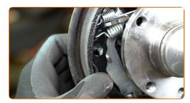
Reinstallare i perni di fermo delle ganasce dei freni. Usa delle pinze a becchi lunghi.
