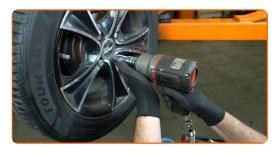
Rimettere il veicolo per terra e, lavorando in ordine incrociato, serrare i bulloni di fissaggio delle ruote. Usa la chiave a bussola per dadi cerchio ruota n.17. Usa una chiave dinamometrica. Serralo fino allo coppia di torsione di 98 Nm.
