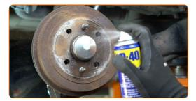
Svitare il supporto di fissaggio del tamburo freno. Utilizza una chiave a bussola N°12. Usa una chiave a cricchetto.
