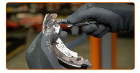
Pulire le sedi di montaggio delle ganasce dei freni. Usa una spazzola metallica. Usa un detergente spray multiuso.
