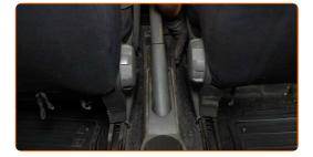
Avvita gli elementi di fissaggio anteriori della console centrale inferiore. Utilizza una chiave a bussola N°10. Usa una chiave a cricchetto.
