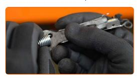
Collegare il cavo del freno di stazionamento al braccio della ganascia freno.
