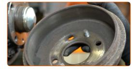
Pulire gli elementi di fissaggio delle ganasce dei freni. Usa una spazzola metallica. Usa lo spray WD-40.
