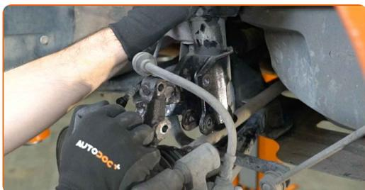
**20** Svitare l'elemento di fissaggio superiore del montante supporto ammortizzazione.
