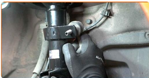
**43** Serra gli elementi di fissaggio che collegano il tirante della barra stabilizzatrice al puntone dell'ammortizzatore. Utilizza una chiave a bussola N°16. Usa una chiave dinamometrica. Serralo fino allo coppia di torsione di 23 Nm.
