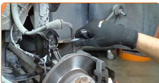
**17** Puntellare il fuso a snodo. Usa un cric idraulico per trasmissione.
