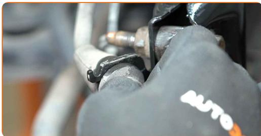
**42** Installa il puntone stabilizzatore trasversale.
