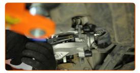
Installare la molla di fissaggio della pinza freno. Usa delle pinze a becchi lunghi.
