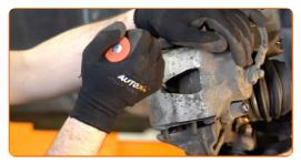
Pulisci l'area nella quale il tubo del freno è connesso alla pinza, e la zona dei perni guida. Usa un pulitore freni.
