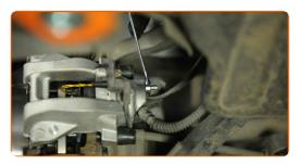
Spurgare la pinza del freno. Senza avviare il motore, premere il pedale del freno più volte finché non viene percepita una resistenza significativa.
