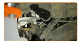
Montare i tappi dei parapolvere delle guide pinza freno.
