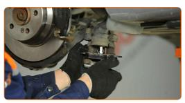
Svitare il tubo flessibile del freno dalla pinza del freno. Utilizzare una chiave poligonale aperta#14.
