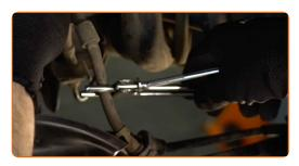
Fissare la staffa supporto del cablaggio ABS.
