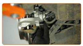
Avvita gli elementi di fissaggio che collegano il tubo flessibile del freno alla pinza del freno. Utilizzare una chiave poligonale aperta#14. Usa una chiave dinamometrica. Serralo fino allo coppia di torsione di 18 Nm.
