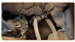
Allentare il fissaggio del tubo flessibile freno. Utilizzare una chiave poligonale aperta#14.
