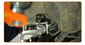
Collegare il sensore di usura delle pastiglie dei freni. Usa delle pinze a becchi lunghi.
