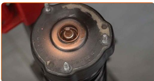
**41** Monta il coperchio di protezione del supporto di ammortizzazione.
