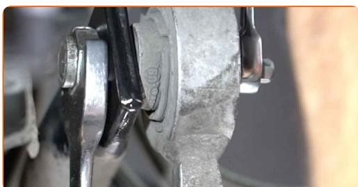
**49** Collega la parte sottostante del puntone dell'ammortizzatore.
