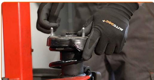
**38** Serrare la vite dell'asta pistone supporto ammortizzazione. Usa la chiave a bussola per ammortizzatore Nr. DD6. Utilizza una chiave a bussola N°18. Usa una chiave dinamometrica. Serralo fino allo coppia di torsione di 23 Nm.
