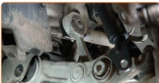
**48** Serra gli elementi di fissaggio del tirante della barra stabilizzatrice. Utilizza una chiave combinata N°21. Usa una chiave HEX N.H12. Usa una chiave a cricchetto.
