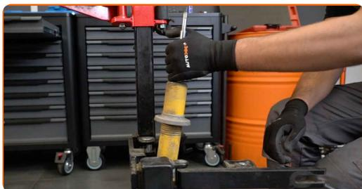
Sostituzione: ammortizzatore a molla - Mercedes W211. Gli esperti di AUTODOC raccomandano:
