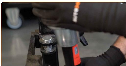
**43** Pulisci le sedi di montaggio del puntone dell'ammortizzatore.
