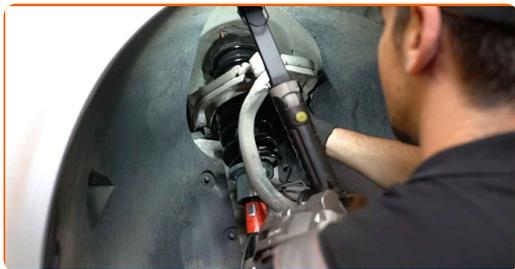
**46** Avvita l'elemento di fissaggio superiore del montante supporto ammortizzazione.
