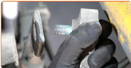
**21** Svita l'elemento di fissaggio superiore del montante supporto ammortizzazione.
