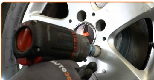
**41** Rimettere il veicolo per terra e, lavorando in ordine incrociato, serrare i bulloni di fissaggio delle ruote. Usa la chiave a bussola per dadi cerchio ruota n.17. Usa una chiave dinamometrica. Serralo fino allo coppia di torsione di 110 Nm.
