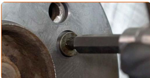
**26** Stringere gli elementi di fissaggio del disco del freno. Usa una chiave HEX N.H5. Usa una chiave dinamometrica. Serralo fino allo coppia di torsione di 10 Nm.
