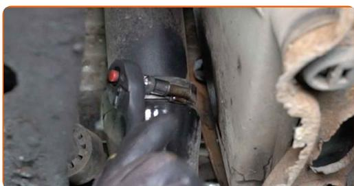
**4** Rimuovere la clip inferiore del tubo dell'intercooler. Usa un piede di porco.
