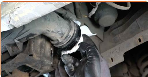
**7** Pulire le sedi di montaggio del tubo dell'intercooler. Usa un detergente spray multiuso.
