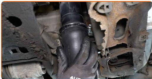
**10** Montare la clip inferiore del tubo dell'intercooler.
