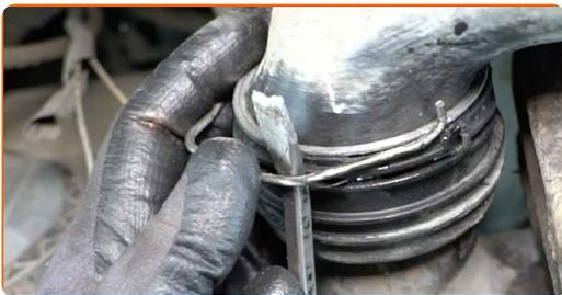
**5** Rimuovere il tubo dell'intercooler (interrefrigeratore).
