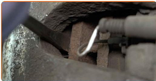
**9** Pulisci gli elementi di fissaggio del supporto pinza freno. Usa una spazzola metallica. Usa lo spray WD-40.
