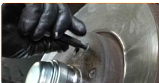
**37** Stringere gli elementi di fissaggio del disco del freno. Usa una chiave HEX N.H5. Usa una chiave dinamometrica. Serralo fino allo coppia di torsione di 10 Nm.
