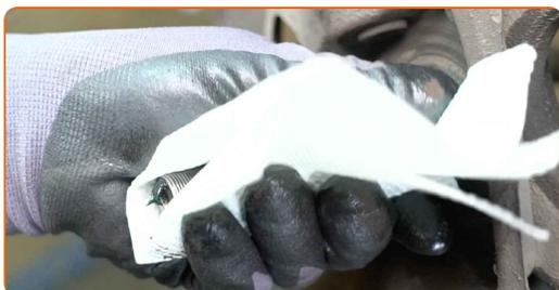
**23** Pulire il sensore ABS. Usare una spazzola pulente in nylon. Usa un detergente spray multiuso.
