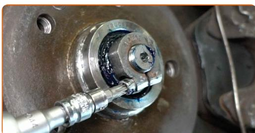
**48** Installare il coperchio del cuscinetto del mozzo. Usa un set di montaggio/smontaggio cuscinetti e boccole.
