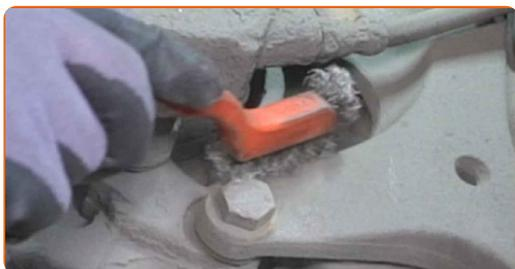
**10** Svitare gli elementi di fissaggio del supporto della pinza del freno. Utilizza una chiave a bussola N°18. Usa una chiave a cricchetto.
