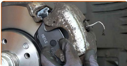
**21** Serra gli elementi di fissaggio della pinza del freno. Usa una chiave HEX N.H7. Usa una chiave dinamometrica. Serralo fino allo coppia di torsione di 25 Nm.
