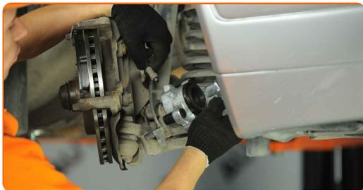
**22** Avvita gli elementi di fissaggio che collegano il tubo flessibile del freno alla pinza del freno. Utilizzare una chiave poligonale aperta#14. Usa una chiave dinamometrica. Serralo fino allo coppia di torsione di 18 Nm.
