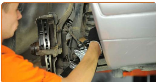
**23** Rimuovi la fascetta di fissaggio del tubo freni.
