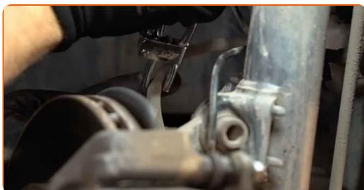
**18** Svitare il tubo flessibile del freno dalla pinza del freno. Utilizzare una chiave poligonale aperta#14.
