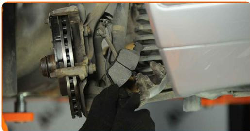
**17** Stringi il tubo del freno usando una fascetta di fissaggio del tubo freni.
