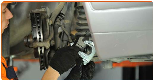
Sostituzione: pinza de freno - Mercedes W210. Gli esperti di AUTODOC raccomandano:
