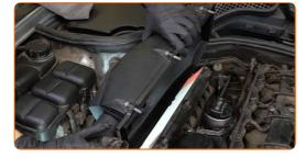
Rimuovere l'elemento filtrante dall'alloggiamento del filtro.
