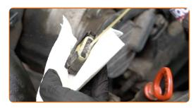
Collegare il connettore del sensore del flusso d'aria di massa.
