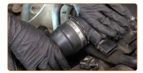
Avvita i morsetti di fissaggio che collegano il condotto dell'aria alla scatola del filtro dell'aria. Utilizza una chiave a bussola N°7. Usa una chiave a cricchetto.
