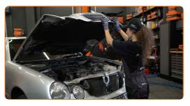
Usa una copertura di protezione del parafango per evitare il danneggiamento della verniciatura e dei componenti in plastica dell'auto.
