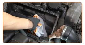
Inserire un nuovo elemento filtrante nell'alloggiamento del filtro.
