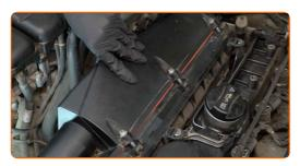
Avvita le viti di serraggio sul coperchio del filtro dell'aria. Utilizza una chiave a bussola N°E11. Usa una chiave a cricchetto.
