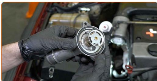
**25** Installare il termostato insieme all'alloggiamento.
