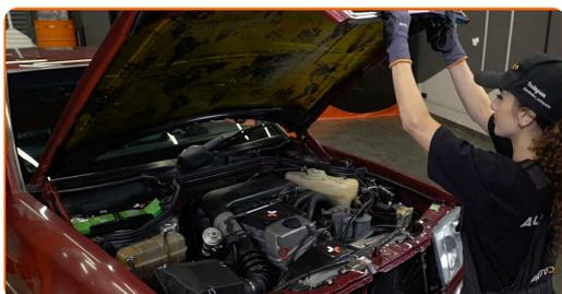
**2** Usa una copertura di protezione del parafango per evitare il danneggiamento della verniciatura e dei componenti in plastica dell'auto.
