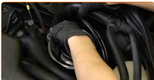
**24** Installare il tappo dell'alloggiamento del filtro dell'olio.
