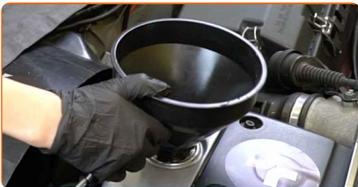
**28** Versa l'olio nel motore attraverso serbatoio. Quantità di olio richiesta: 6.5 l.
