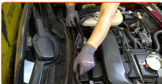
**4** Rimuovere l'elemento centrale che trattiene la guarnizione del pannello di copertura del parabrezza.
