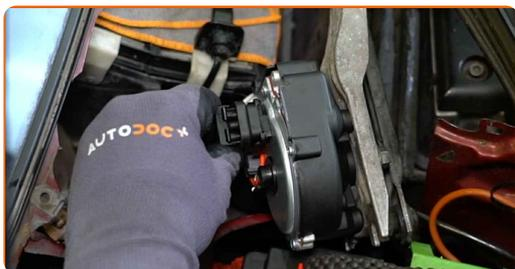
**31** Serrare gli elementi di fissaggio del meccanismo del tergicristallo. Utilizza una chiave a bussola N°10. Usa una chiave dinamometrica. Serralo fino allo coppia di torsione di 13 Nm.
