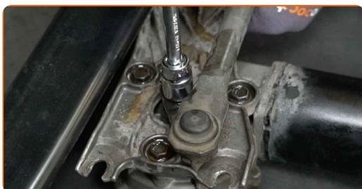
**17** Svitare gli elementi di fissaggio del motorino del tergicristallo. Utilizza una chiave a bussola N°10. Usa una chiave a cricchetto.
