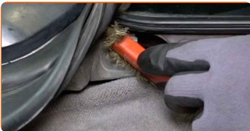
**11** Svitare gli elementi di fissaggio del meccanismo del tergicristallo. Utilizza una chiave a bussola N°10. Usa una chiave a cricchetto.
