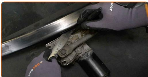
**15** Pulire gli elementi di fissaggio del motorino del tergicristallo. Usa una spazzola metallica. Usa lo spray WD-40.
