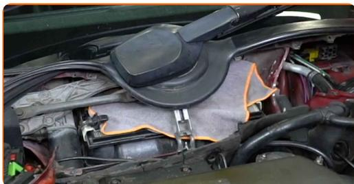
**10** Pulire gli elementi di fissaggio del meccanismo del tergicristallo. Usa una spazzola metallica. Usa lo spray WD-40.
