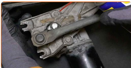
**16** Svitare l'elemento di fissaggio che collega il leveraggio all'albero del motorino del tergicristallo. Utilizza una chiave a bussola N°13. Usa una chiave a cricchetto.
