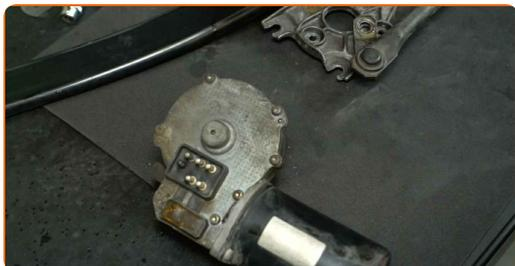
**21** Pulire la sede di montaggio del motorino del tergicristallo. Usa una spazzola metallica. Usa un detergente spray multiuso.
