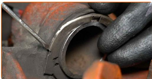
**28** Rimuovere il pistone dall'alloggiamento della pinza del freno.
