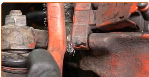
**10** Svitare l'elemento di fissaggio del connettore del sensore di usura delle pastiglie dei freni. Utilizza una chiave combinata N°10.
