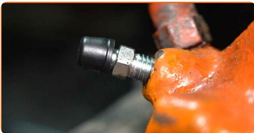
**62** Installare il connettore del sensore di usura delle pastiglie dei freni.
