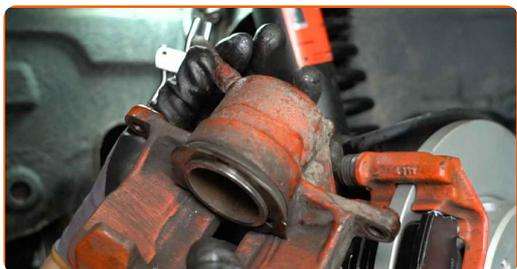
**21** Svitare il tubo flessibile del freno dalla pinza del freno.
