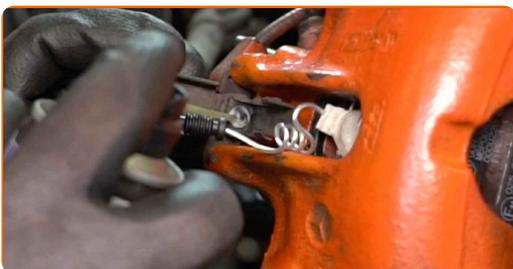
**66** Collegare il connettore del sensore di usura delle pastiglie dei freni.
