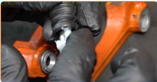
**43** Installare i perni di guida della pinza del freno.
