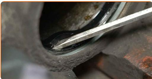
**33** Pulire le sedi di montaggio del pistone e dei relativi componenti. Usa una spazzola metallica. Usare una spazzola pulente in nylon. Usa un detergente spray multiuso.
