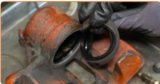
**32** Rimuovere l'anello di tenuta O-ring del pistone della pinza. Usa un giravite piatto.
