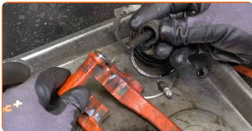
**35** Pulire i perni di guida e le rispettive sedi sulla staffa della pinza del freno. Usa una spazzola metallica. Usare una spazzola pulente in nylon. Usa un detergente spray multiuso.
