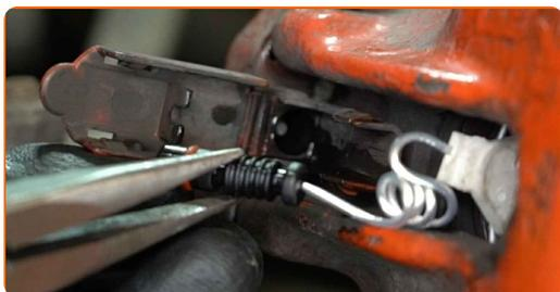
**9** Pulire l'elemento di fissaggio del connettore del sensore di usura delle pastiglie dei freni. Usa una spazzola metallica. Usa lo spray WD-40.
