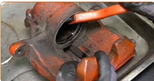
**34** Rimuovere i perni di guida della pinza del freno.
