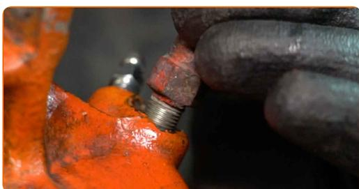
**51** Installare la pinza del freno e fissarla.
