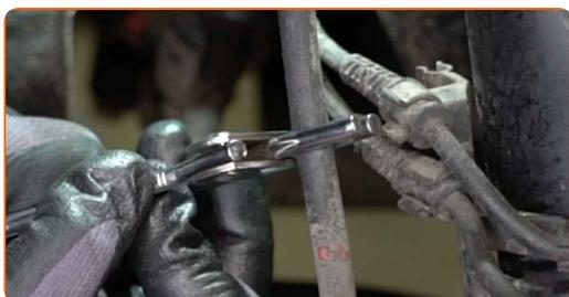
**15** Allentare l'elemento di fissaggio del tubo del freno. Utilizza una chiave combinata N°14.
