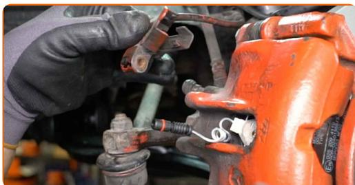
**13** Pulisci la sede di montaggio del tubo flessibile del freno alla pinza freno. Usa una spazzola metallica. Usa lo spray WD-40.
