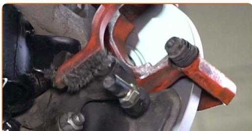
**24** Svitare gli elementi di fissaggio del supporto della pinza del freno. Utilizza una chiave combinata N°19.
