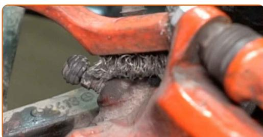
**14** Stringi il tubo del freno usando una fascetta di fissaggio del tubo freni.
