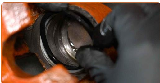
**37** Installare il nuovo soffietto parapolvere per il pistone della pinza del freno.
