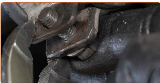
**18** Serrare gli elementi di fissaggio sulle staffe delle boccole della barra stabilizzatrice. Utilizza una chiave combinata N°13. Utilizza una chiave a bussola N°13. Usa una chiave dinamometrica. Serralo fino allo coppia di torsione di 20 Nm.
