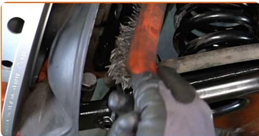
**7** Svita le staffe di fissaggio delle boccole dello stabilizzatore. Utilizza una chiave combinata N°13. Utilizza una chiave a bussola N°13. Usa una chiave a cricchetto.
