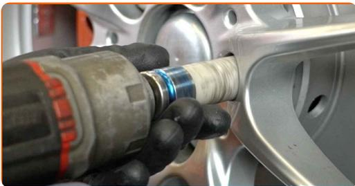
**23** Rimettere il veicolo per terra e, lavorando in ordine incrociato, serrare i bulloni di fissaggio delle ruote. Usa la chiave a bussola per dadi cerchio ruota n.17. Usa una chiave dinamometrica. Serralo fino allo coppia di torsione di 110 Nm.
