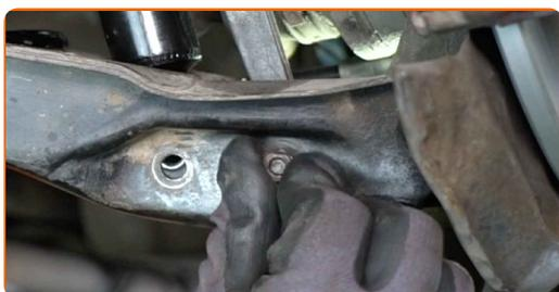
**39** Posizionare l'ammortizzatore nel passaruota e fissarlo.
