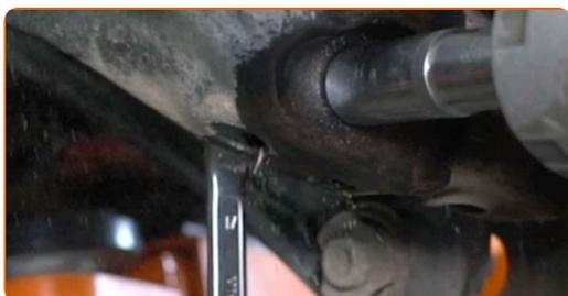
**13** Svitare il fissaggio superiore dell'ammortizzatore.
