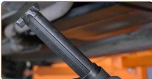
**33** Pulisci la sede di montaggio dei cerchioni della ruota. Usa una spazzola metallica. Usa un detergente spray multiuso.
