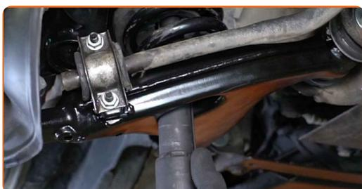
**32** Rimuovi il compressore per molle elicoidali.
