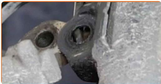
**14** Pulisci le staffe di fissaggio delle boccole dello stabilizzatore. Usa una spazzola metallica. Usa lo spray WD-40.
