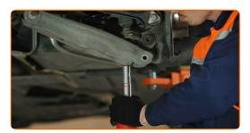
Stringi l'elemento di fissaggio inferiore dell'ammortizzatore. Utilizza una chiave a bussola N°E12. Usa una chiave dinamometrica. Serralo fino allo coppia di torsione di 47 Nm.
