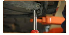
Pulisci gli elementi di fissaggio dell'ammortizzatore. Usa una spazzola metallica. Usa lo spray WD-40.
