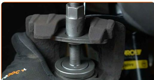
**29** Montare la pinza del freno e fissarla. Utilizza una chiave a bussola N°13. Usa una chiave dinamometrica. Serralo fino allo coppia di torsione di 30 Nm.
