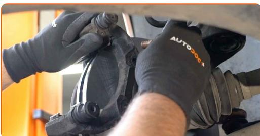
**25** Serrare il sostegno pinza freno. Usa la chiave Torx T55. Usa una chiave dinamometrica. Serralo fino allo coppia di torsione di 105 Nm.
