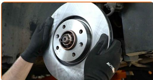
**20** Serrare l'attacco del disco freno. Usa la chiave Torx T30. Usa una chiave dinamometrica. Serralo fino allo coppia di torsione di 9 Nm.
