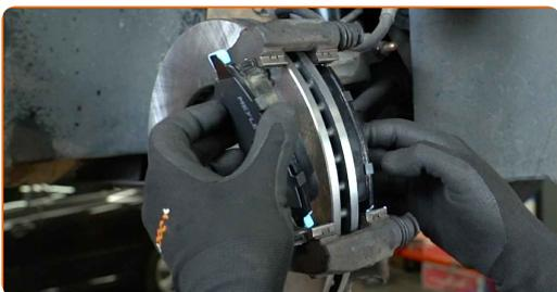
**27** Tratta con del prodotto il pistone della pinza freno. Usare una spazzola pulente in nylon. Usa un pulitore freni.
