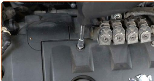
**4** Rimuovere la copertura del motore.
