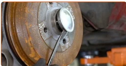
**7** Svitare l'elemento di fissaggio del mozzo della ruota. Utilizza una chiave a bussola N°30. Usa un giramaschi.
