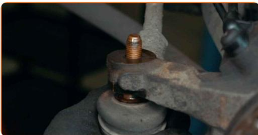
**56** Avvita il dado di serraggio che collega le testine tiranti dello sterzo al fuso a snodo. Utilizza una chiave a bussola N°16. Usa un giramaschi.
