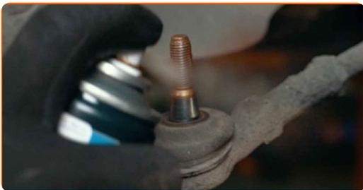
**54** Pulisci le sedi di montaggio delle testine tiranti dello sterzo. Usa una spazzola metallica. Usa lo spray WD-40.
