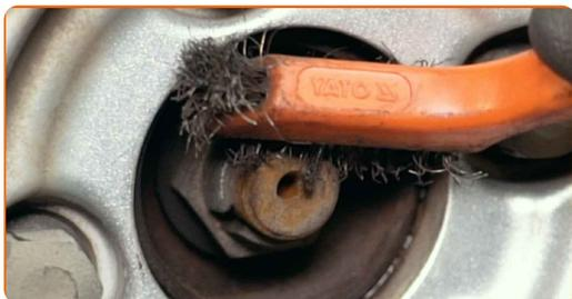
**2** Allenta l'elemento di fissaggio dell'albero di trasmissione. Utilizza una chiave a bussola N°30. Usa un giramaschi.
