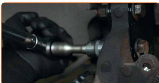
**53** Tratta con del prodotto l'elemento di fissaggio che collega la testina tirante al fuso a snodo. Usa il grasso al rame.
