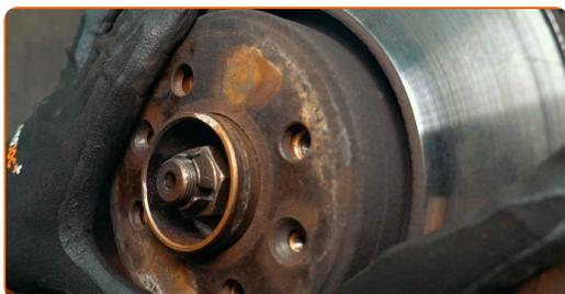
**65** Serrare l'attacco del disco freno. Usa la chiave Torx T40. Usa una chiave dinamometrica. Serralo fino allo coppia di torsione di 14 Nm.
