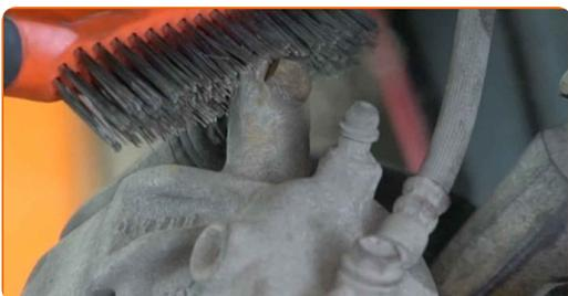
**10** Svitare gli elementi di fissaggio della pinza del freno. Utilizza una chiave combinata N°13. Utilizza una chiave combinata N°15.
