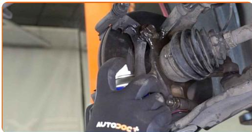
**15** Svitare gli elementi di fissaggio del supporto della pinza del freno. Utilizza una chiave a bussola N°17. Usa una chiave a cricchetto.
