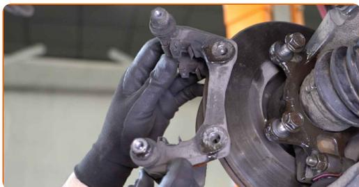
**18** Pulisci gli elementi di fissaggio del disco freno. Usa una spazzola metallica. Usa lo spray WD-40.
