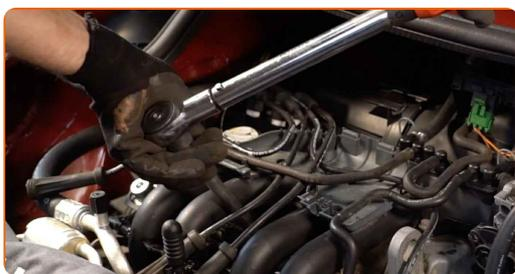
**Sostituzione: candele di accensione - DACIA Dokker Station Wagon (KE\_). Gli esperti di AUTODOC raccomandano:**
