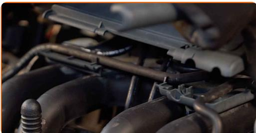
**4** Rimuovi ilcavi connettori della candela dai loro fori. Usa delle pinze a becchi lunghi.
